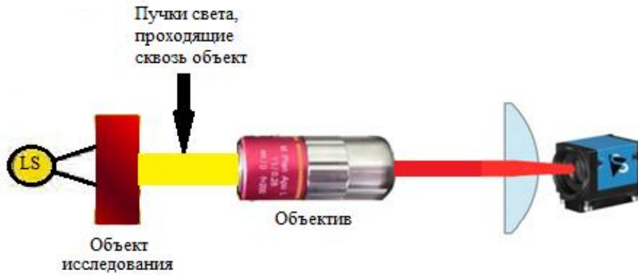
Рисунок 1 – Схема экспериментальной установки
