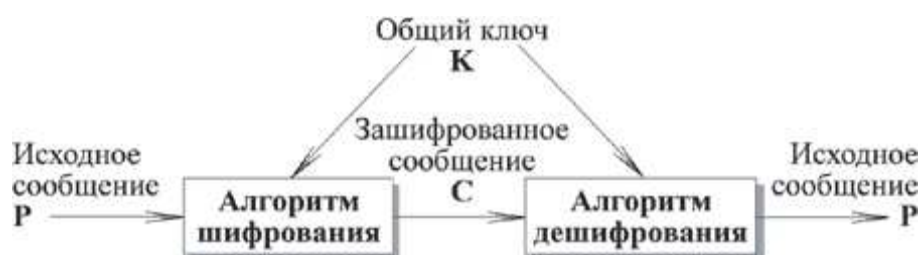
Рисунок 2.1 Общая схема симметричного шифрования
