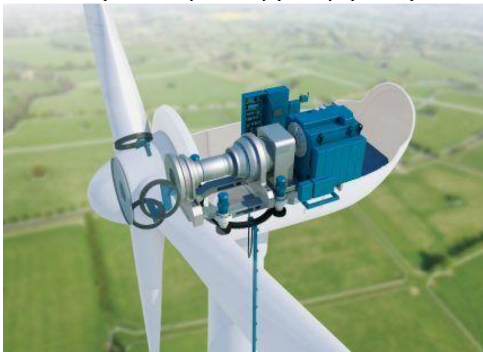
Рисунок 3. Внутреннее устройство работы ветряка
