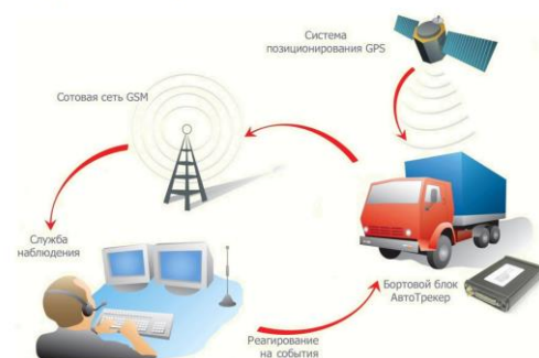
Рис. 4. Общая схема работы системы мониторинга
