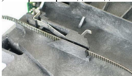
Рис. 6.13. Место крепления ремня к сканирующей каретке
