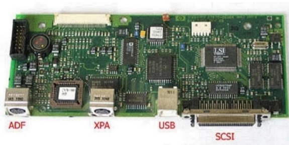
Рис. 6.12. SCSI- и USB-порты в интерфейсной плате
